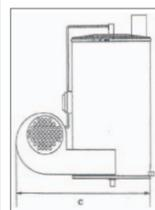
Questo tipo di caldaia offre il massimo dei rendimenti in uno spazio limitato mantenendo anche una caratteristica pressoché unica; infatti grazie ad una camera ventilata e ad un'altra camera che funge da isolamento è riuscita a mantenere bassissime le temperature esterne anche in pieno funzionamento.
